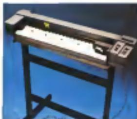
Formato compreso tra A0 ed A4 con risoluzione indichabile di 0,025 mm ad una velocità di 80 cm/sec. Otto penne con selezione automatica e ripetibilità maggiore o uguale a 0,1 mm. Il protocollo impiegato è HP-GL con interfaccia RS 232C o via IEEE 488. Tra le caratteristiche offerte da questo plotter il self test è l'autodiagnostica. Il prezzo, non ancora ufficiale, dovrebbe essere di circa 25.000.000 di lire (IVA esclusa).
